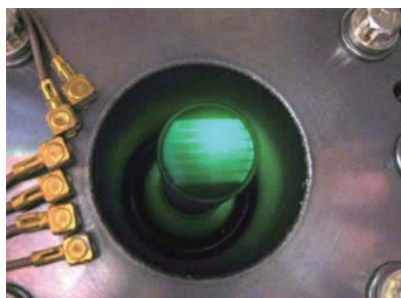
微通道板增强器的响应（碘化铯涂层的光电阴极）
