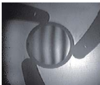
图像品质滤光片的干涉图像
