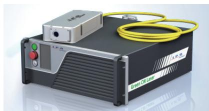
GLR 是单模、单频连续绿光激光器系列，最高功率可达 100W，基于高效且可靠的光纤激光器技术，采用超紧凑的轻量级光学头，风冷式主机。全光纤结构允许全范围输出功率调整，且不改变功率稳定性和光束模组等参数。
