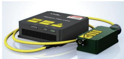
GLPN 532nm 纳秒光纤激光器 在 10-1000KHz 范围、提供 10-100W 平均功率和 1-10ns 脉冲，30-40μJ 脉冲能量，峰值功率高，适用于太阳能\光伏行业加工、透明材料达标和精确调阻等精密加工应用。
