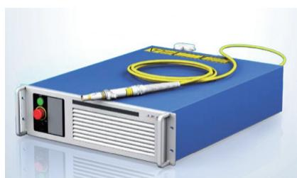
YLM 和 YLR 系列单模连续 (CW) 掺镱光纤激光器独特地兼具高功率、高稳定性、理想光束质量、光纤传输、超长寿命和卓越的电光转换效率。这些激光器可在高达 50 kHz 的频率下进行调制。紧凑型 YLM 模块的功率高达 400 W, 19 英寸机架式 YLR 配备包括高达 700 W 的风冷式装置和高达 4 kW 的水冷式装置。单模激光器的输出功率高达 2 kW，可通过准直器或 QBH 插入式连接器进行集成。
