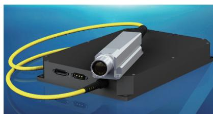
单模连续，最大功率 20W 连续可调，波长 515,530,590,615,635nm 可选， $M^2 < 1.1$ , 1% 功率稳定性，超紧凑轻量化光学头。
