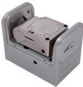
针对 <450nm 的波段，目前无法找到合适的滤光片实现“猫眼”结构。Moglabs 通过优化的 Littrow 结构实现更好的稳定性，纯接触无弹簧的“DESMO”调节机构确保了振动免疫；光栅的两个调节方向实现解耦，确保在 LD 增益范围内扫频时，无需腔准直调节。
