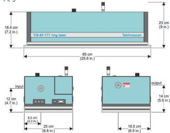
TIS-SF-777 超窄线宽连续可调钛宝石激光器是 Tekhnoscan 经典产品，可实现 2-3kHz 窄线宽输出，主要得益于高精度自动稳定调节腔体及快速压电控制反射镜，配合精密的电路控制，保证激光器输出频率超窄线宽、超高的稳定性及快速方便的操控。
