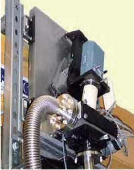
左边照片为 McPherson 248/310G 使用无窗背后照明无镀膜 CCD 探测器，可以直接测量 soft x-ray 和 EUV 光谱。CCD 垂直于出射光束。CCD 中心是最好的焦点。CCD 可以在 Rowland circle 上扫描使得任意波长时光束都打在探测器的中心。
