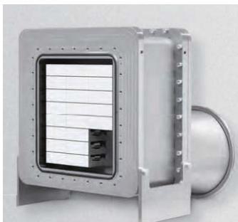
PILATUS3 2M-DLS-L 设计用于收集 WAXS 信号，同步在 DLS (Diamond Light Source) I22 光束源上同时进行了 SAXS、WAXS 测量。此探测器基于 PILATUS3 2M 平台，提供了一个由 21 个 PILATUS3 模组组成的 L 形的探测面。L 形是通过在 8×3 的矩形阵列的一个角落中省略三个检测器模块来实现的。主波束和小角度散射信号可以直接通过直接连接在探测器背面的疏散飞行管，另一个 PILATUS3 2M 则探测在飞行管末端下游的 SAXS 信号。
