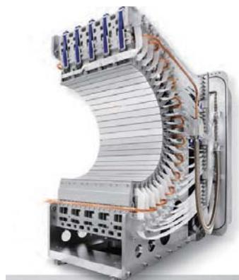
长期以来，利用长波长进行反常相位的方法一直受到强空气吸收和大散射角的阻碍。DECTRIS 与钻石光源 (DLS) I23 团队紧密合作，打造的 PILATUS 12M specific 解决方案有效地克服了这些限制。将样品和检测器置于真空中，消除了空气的吸收和散射。
