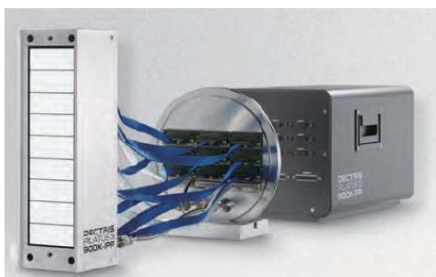
此 PILATUS 900K-IPP 是为中国合肥的等离子体物理研究所而设计的！此探测器是由 9 个 PILATUS 模组组成，安装于一台新型的 X-RAY 影像晶体谱仪 (XICS) 上，此谱仪用于在探测 EAST Tokamak 装置上 X-RAY 能谱范围从 3.1KeV (Ar 特征发射) 到 13KeV (Kr 特征发射)。
