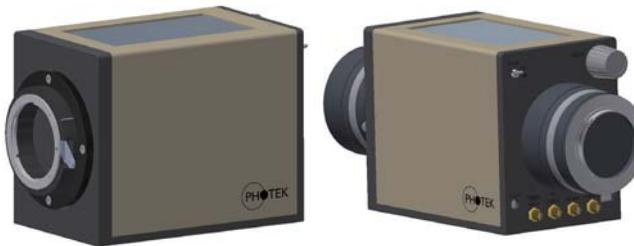
ILCI-25 高度一体化设计，内部集成了 MCP125 或 MCP225 像增强器，可以提供光电转换，增益以及高速快门功能，专门特殊设计用来通过 Nikon F 接口安装到用户已有的 CCD 相机，EMCCD 或高速摄相机上面，可以方便快速组合成高速或超高速 ICCD。
