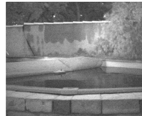
SWIR 波段夜视成像。 在无月夜条件下对游泳池中的船只进行成像。使用设备: C-RED 2, 相配 16 mm SWIR 镜头, 制冷至 -15^{\circ}\text{C} , 高增益模式。
