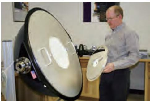
HalfMoon 半月型测试系统 专为固态照明灯具中的前通量灯、LED、板式安装的热沉式 LED 而设计，半球内部使用 Spectrareflect® 涂料，使用一块内部为镜子的盖板封住半球，镜面与半球形成一个虚拟的完整的积分球。HalfMoon 半球直径有 12,20,40 英寸 3 中规格。测试时，打开中心部位的安装开口，向内安装待测设备，同时在外部控制待测设备的电源和温度。与传统积分球设计相比，这种方式有利于最大程度地减少因吸收产生的误差。
