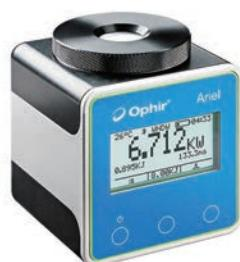
Ariel 可测量高达 8kW 的激光功率，集成显示屏，可单独使用也可连接电脑使用。
